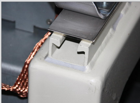
veilige en flexibele bevestiging van zware elektrische componenten in treinen
