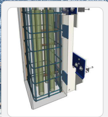
JUB-3, AAN BETON Opvang liggers weerszijden + bovenstaande kolom
