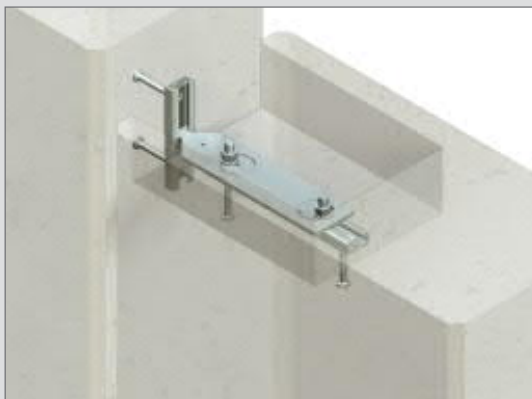
Aansluiting met verbindingsstrip JVB-V aan de voorkant
