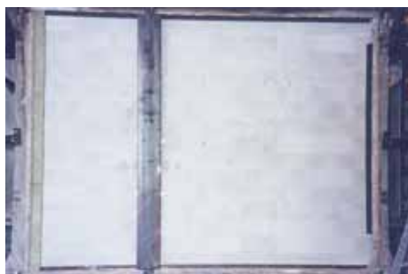
Foto van een brandproefopstelling van een 120 mm kalkzandsteen lijmblokken wand tussen dubbele kolommenrij uitgevoerd bij TNO-CVB te Rijswijk.
