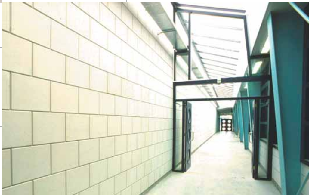
Foto van een brandproefopstelling van een 120 mm kalkzandsteen lijmblokken wand tussen dubbele kolommenrij uitgevoerd bij TNO-CVB te Rijswijk.
